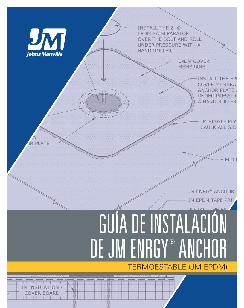
JM ENRGY™ Anchor es una solución de montaje fotovoltaico (FV) ligero y de integración en el techo que consta de una placa de acero revestida y un montante de acero inoxidable y una membrana de cobertura JM.
